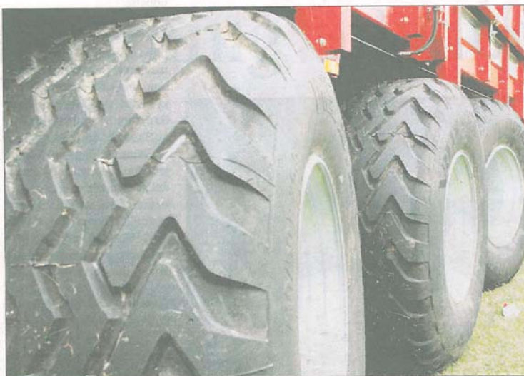
- For løbende at kunne tilpasse dæktrykket til de skiftende driftsbetingelser i løbet af en arbejdsdag, må køretøjet være udrustet med et system til regulering af lufttrykket i dækkene, anbefaler ny FarmTest. (Arkivfoto: John Ankersen)
